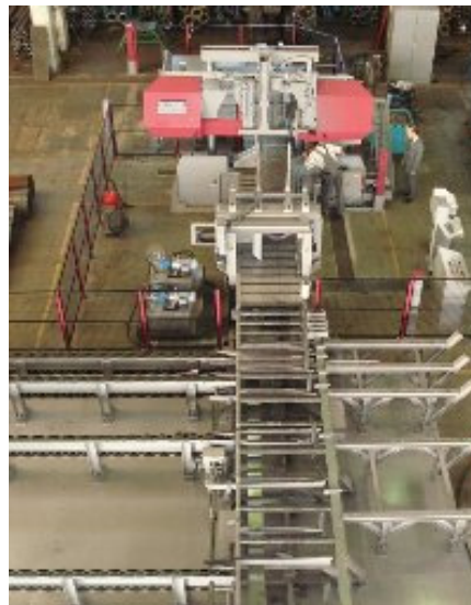
Со стороны подачи ленточнопильный станок оснащён приводным роликовым конвейером и цепными магазинами, на которых лежат подлежащие распиловке трубы
