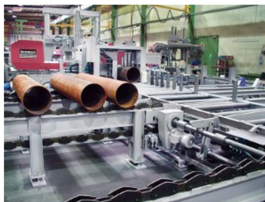
Со стороны подачи ленточнопильный станок оснащён приводным роликовым конвейером и цепными магазинами, на которых лежат подлежащие распиловке трубы
