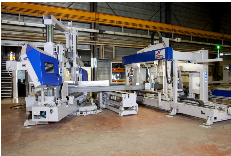
HD-X 1818 – HBP 600/1803 G Линия сверления/пиления с сечением 1800x600 мм
